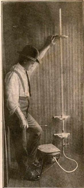
Sous la pression du pied, le soufflet est mis en action. L'air chasse dans le tube les graines de tabac qui s'élevaient à des hauteurs différentes selon leur densité, tandis que les graines mauvaises sont projetées hors du tube.
